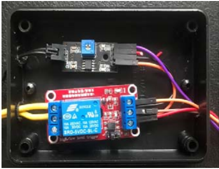
Kết nối đầu cảm biến với bộ chuyển đổi
