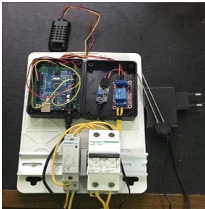
(c) Gắn bộ điều khiển lên đế nhựa
